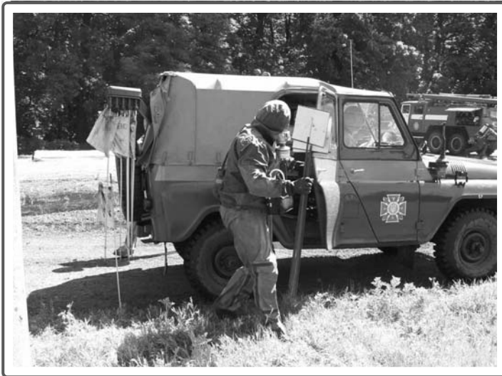
Автомобіль хіміко-радіологічної лабораторії та хімічно-розвідувальна машина на базі УАЗ-469
